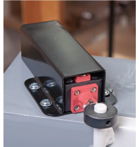
Upper door micro switch assembly
